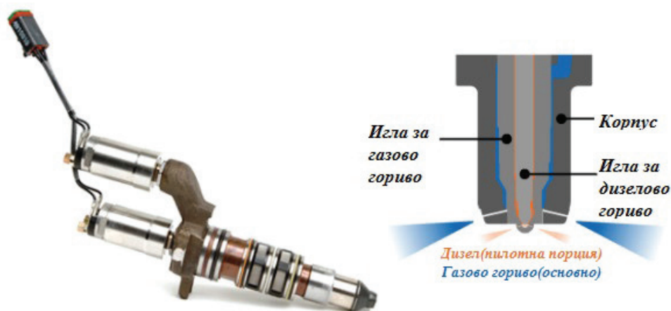
Фиг.2. Горивна дюза за две горива - газово и дизелово гориво.
