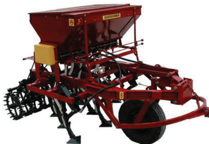
Фиг.2 Общ вид на сеялка култиватор СКС-2.
