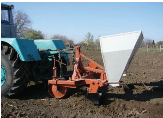
Фиг. 1 Прорезвач ходообразувател ЩН-2-140 с бункер за мулч
