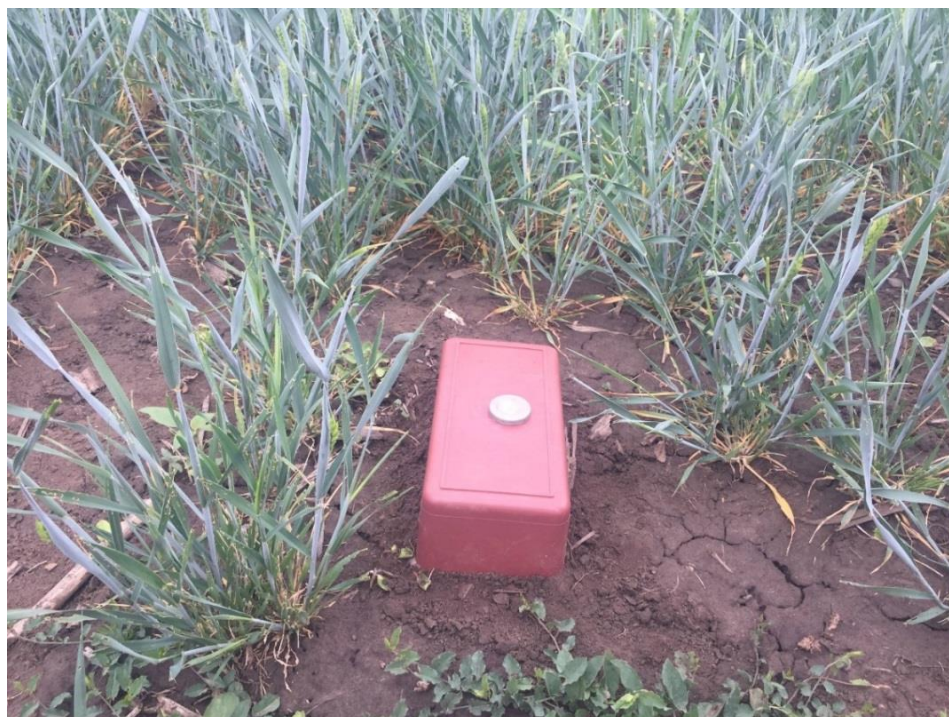
Фиг.2 Пластмасова камера за отчитане на емисиите на CO 2
