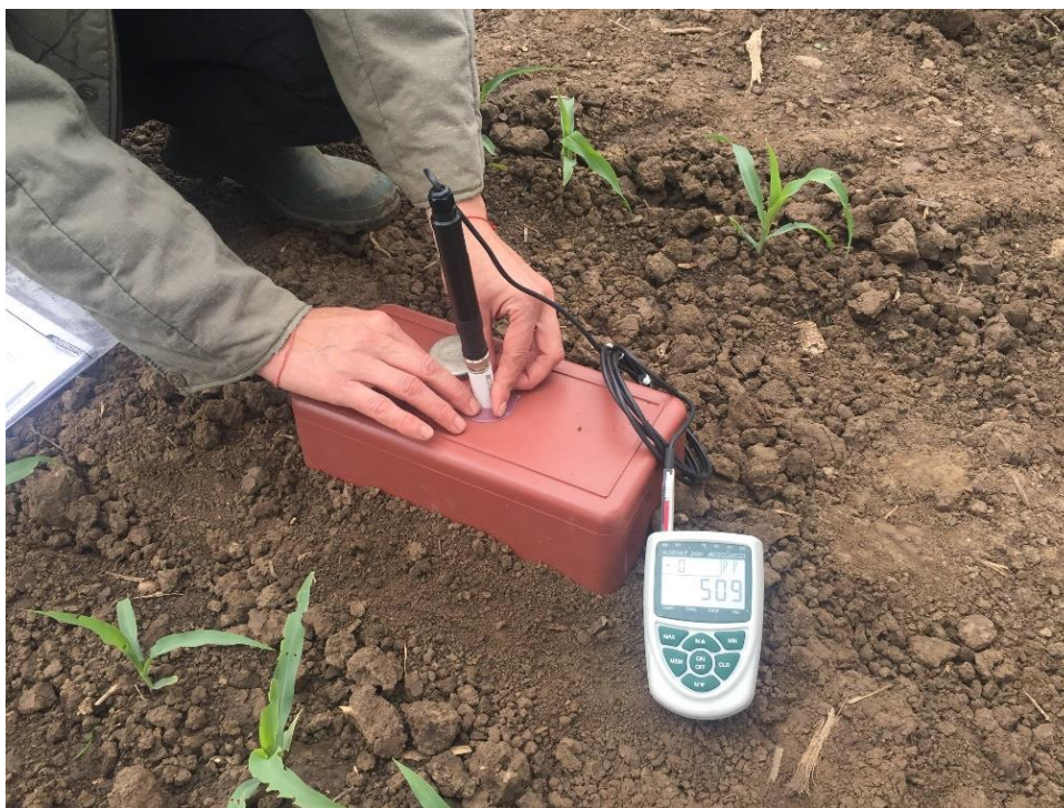
Фиг.3 Измерване натрупаните в камерата емисии на CO 2
