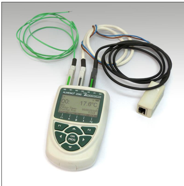
Фиг.1 Апарат „ALMEMO“ със сензор за измерване на CO 2
