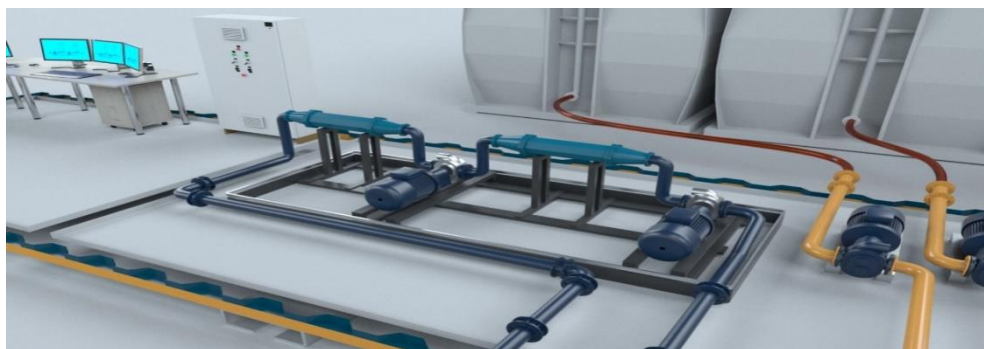
Фиг.2.Компютъризирана система за дозиране и смесване на смазочни масла чрез управляема кавитация.
