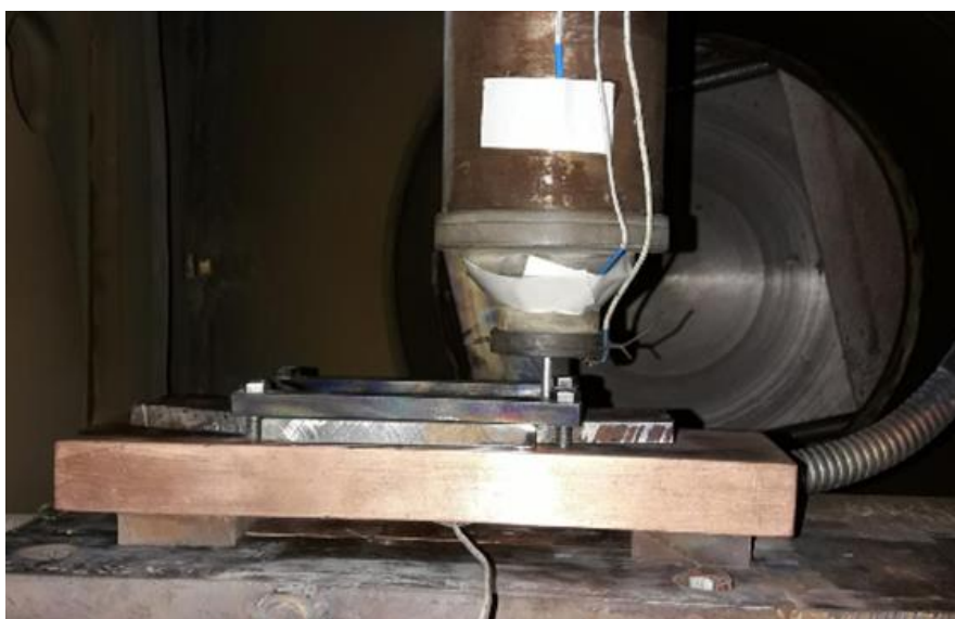
Фиг. 1. Вакуумна камера за електродъгово заваряване във вакуум
