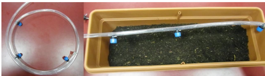
Фиг. 5. Водна тръба и капко-разпръсквателите по тръбата
