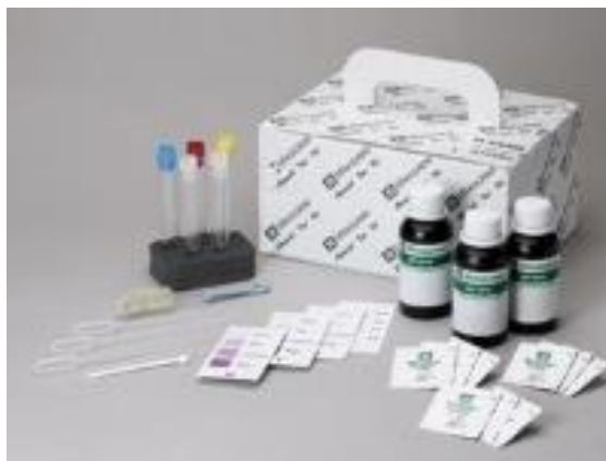
Фиг. 3. Почвен кит за измерване на концентрацията на трите основни химични елемента азот, фосфор и калий в проба от почвата
