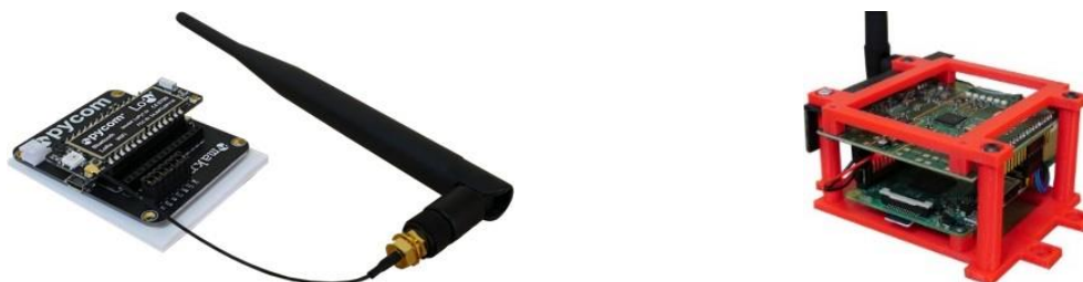
Фиг. 2. LoraWAN концентратор – IMST IC880A (дясно) и Rusom LoPy (ляво)
