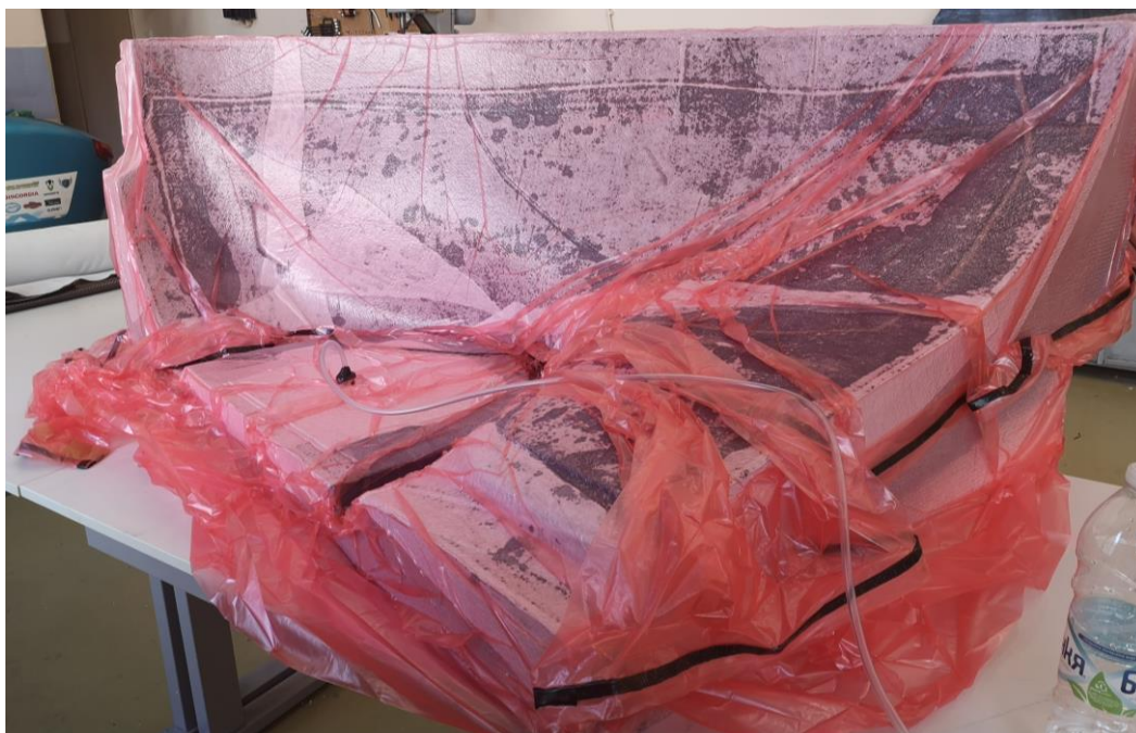
Фиг. 2 Подготовка на интериорни и екстериорни детайли за изработка с използване на вакуумни ламинатни технологии
