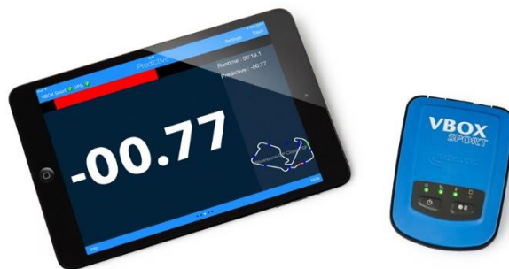
Фиг. 7 VBOX Sport регистратор на данни приложение на iPad за визуализация на данните
