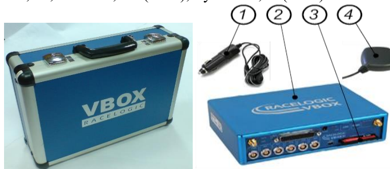
Фиг. 1. VIBOX3i 1- Захранващ кабел; 2-GPS модул; 3- SD карта; 4-GPS антена
