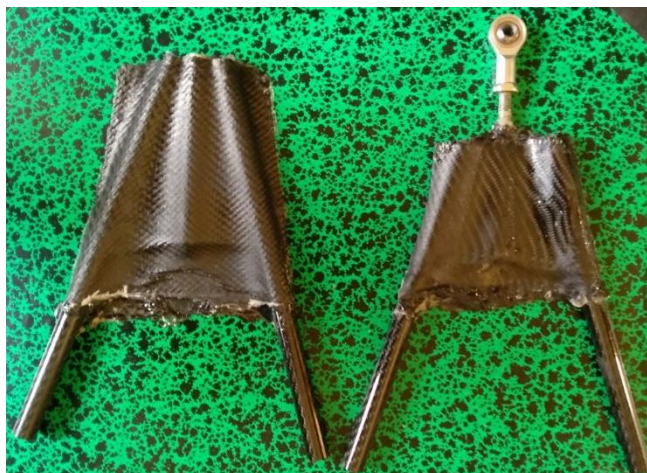
Фиг. 5. Изработените носачи от въглеродни композити
