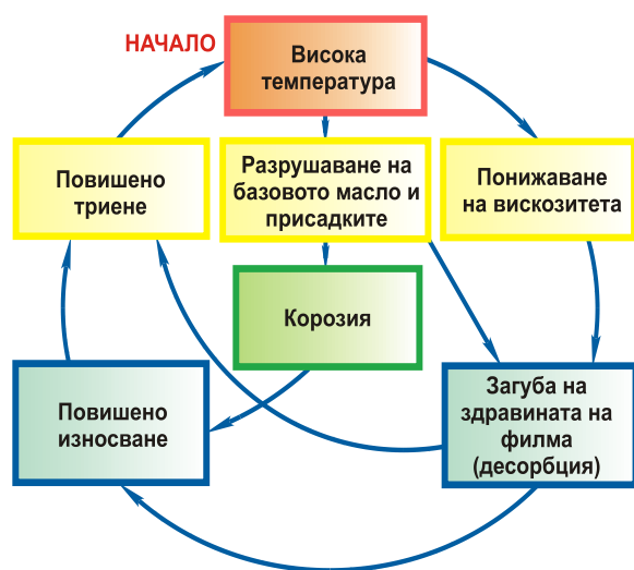
Фиг. 2. Последници от термичното разлагане на маслото
