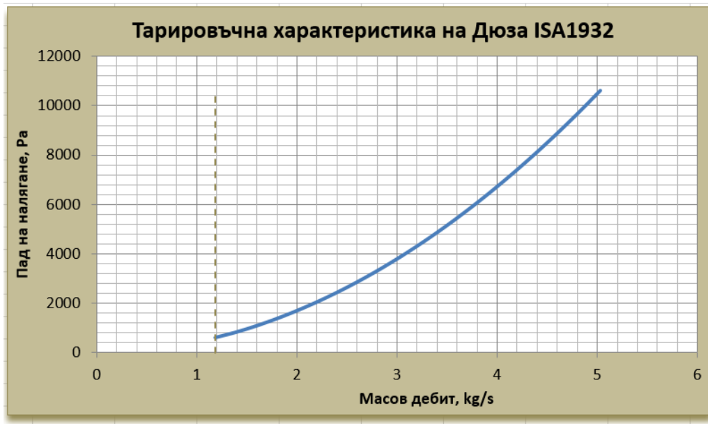
Фиг. 6. Примерна статична тарировъчна характеристика на дюза ISA 1932
