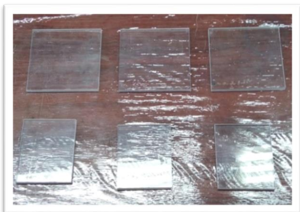
Фиг. 4. Изграждане леглата на полиестерната матрица
