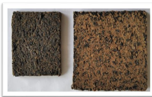
лява плочка: 60 % гумени мленки 20 % дървесни частици; размер: 71 mm x 71 mm x 4 mm дясна плочка: 60 % дървесни частици 20 % гумени мленки; размер: 80 mm x 10 mm x 4 mm
