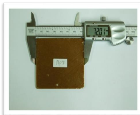
Фиг. 6. Образци от полиестерната матрица: вляво - (пробно тяло № 7 с размери 71 mm x 71 mm x 4 mm ; вдясно – пробно тяло № 10 с размери 80 mm x 10 mm x 4 mm)
