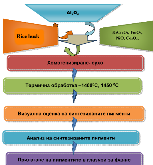
Фиг. 1 Технологична схема за синтез на мулитови пигменти.
