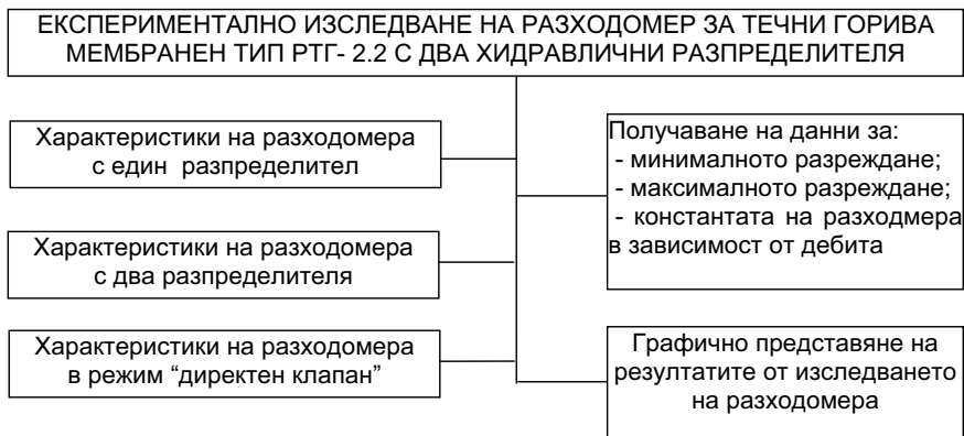
Фиг.4. Блокова схема на лабораторното експериментално изследване на разходомер тип РТГ – 2.2.
