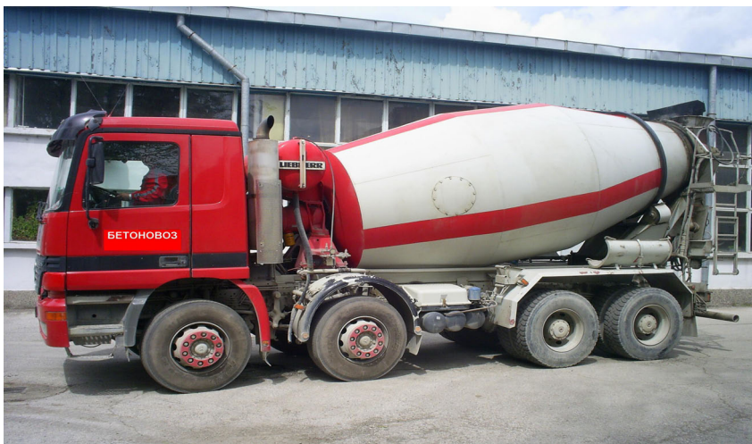
Фиг.1. Автомобил Мерцедес бетоновоз
