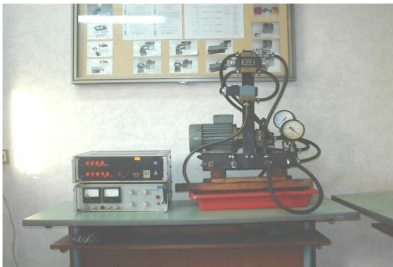
Фиг.3. Общ вид на уредба за снемане на калибровъчна характеристика на РТГ
