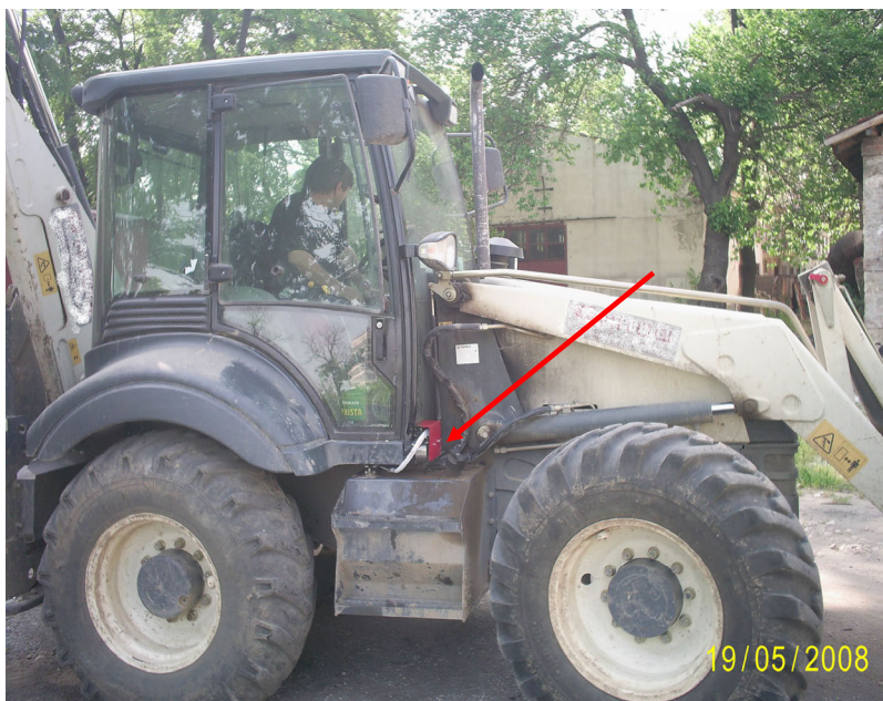
Фиг.1. Общ вид на багер Терекс с вграден разходомер
