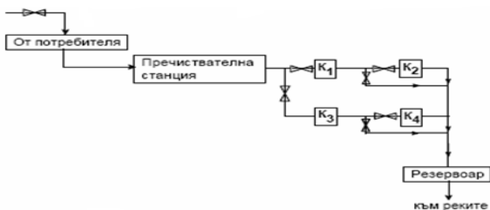
Фиг. 6. Схема за кавитационно почистване на отпадни води.
