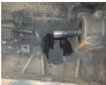
Фиг. 6 Поражения от дефектирала (разрушена) мотовилка.
