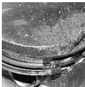
Фиг. 9 Разрушени канали на буталните пръстени.
