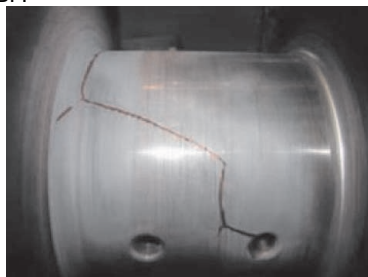
Фиг. 3 Уморни микропукнатини върху шийките на колянвия вал
