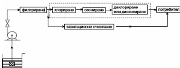
Фиг. 5. Схема за кавитационно почистване на води за нуждите на хранителната промишленост
