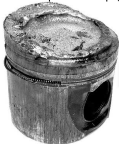
Фиг. 8 Разтопено чело на буталото на дизелов двигател..
