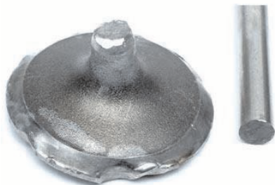
Фиг. 5 Разрушен клапан.
