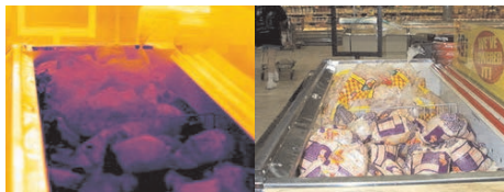
Фиг. 8 Приложение на термографията в хранителната промишленост
