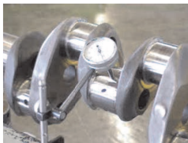
Фиг. 2: Проверка за отклонение от оста на колян вал
