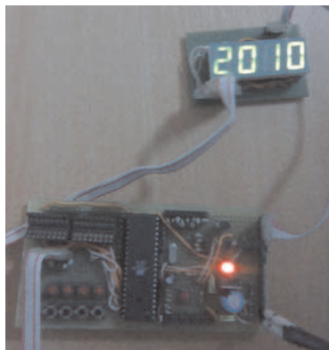
фиг.4. Електронна система на универсален високоскоростен брояч с микроконтролер
