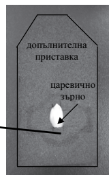
Фиг. 2. Спектрофотометър NIRSystem 6500 и допълнителна приставка за снемане на спектрални характеристики на единични зърна
