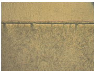
Фигура 3. Микроструктура в напречен шлиф на стомана 4Х5МФС с многослойно покритие от азотиран Ti по режим 3 и TiN, Обр. 206х1000
