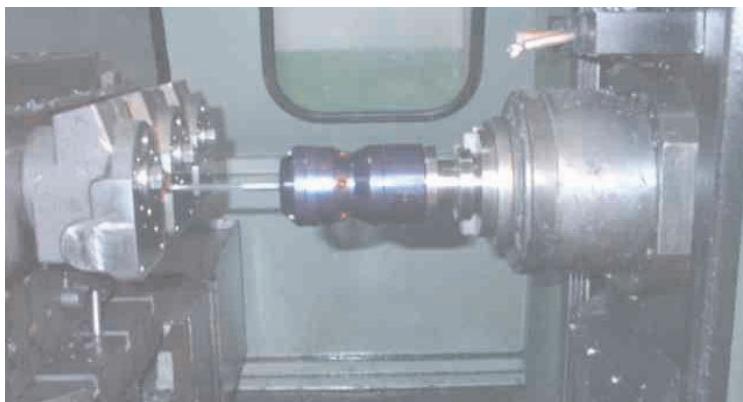
Фиг. 1 Измерване на повърхнини от детайл с ТИГ
