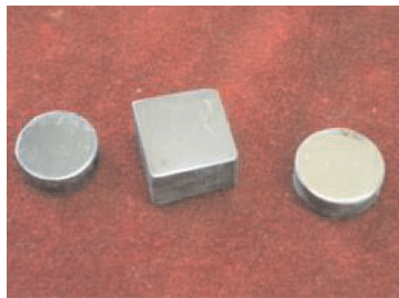
Фиг. 2. Външен вид на покритието ляво - режим № 5, стоманена и магнезиева подложки дясно - режим № 6, стоманена подложка
