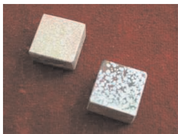
Фиг. 1. Външен вид на покритието след почистване в тлеещ разряд ляво – L_{МП} = 75 mm дясно – L_{МП} = 90 mm
