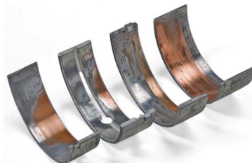
Фиг. 9 Неравномерно износени плъзгащи лагер.
