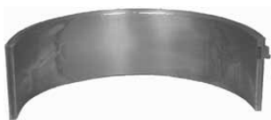
Фиг. 4 Нормално износен плъзгащ лагер
