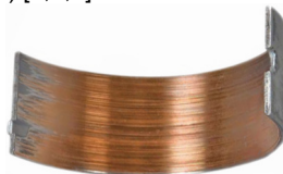
Фиг.5 Плъзгащ лагер със следи от абразивно износване.
