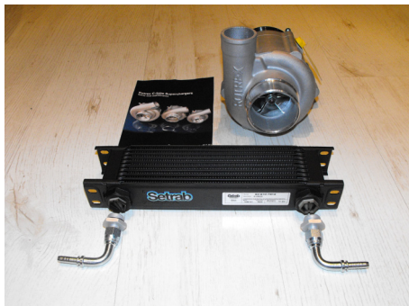
Фиг. 3 Центробежен механичен компресор и маслен радиатор
