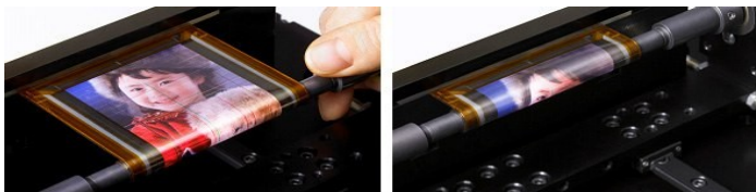
Фиг. 2. 4.1" прототип на гъвкав дисплей
