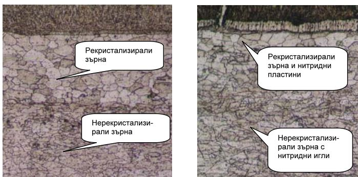
Фиг. 2. Микроструктура на подложката преди и след оксикарбонитриране (x200).
