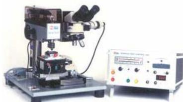
Фиг. 4. Scratch-тестер CSEM-REVETEST®:
