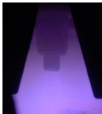
Фиг. 2 Магнетронен разряд
