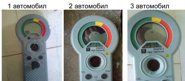
Фиг. 7. Състояние на маслото при измерване с метода за „остатъчен ресурс с ТМЕН 1“ при различните автомобили.
