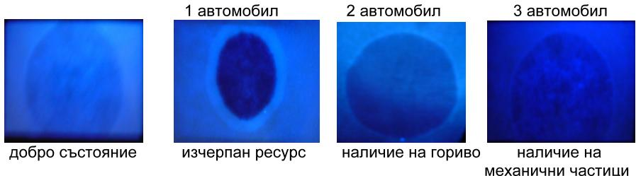
Фиг. 8. Състояние на маслото с метода „**попивателен тест**“ на различните автомобили.
