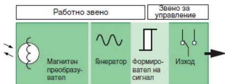
Фиг. 2 - Блокова схема на индуктивен първичен преобразувател
