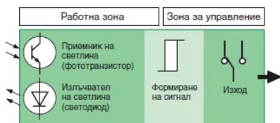
Фиг. 3 - Принцип на работа на фотоелектрически първични преобразуватели
