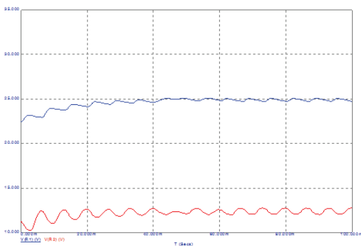
Фиг. 5 - Изходни напрежения на токоизправителите при активно-капацитивен товар
