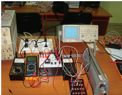
Фиг. 7 - Фотоси на опитната установка за изследване на трифазните токоизправители
