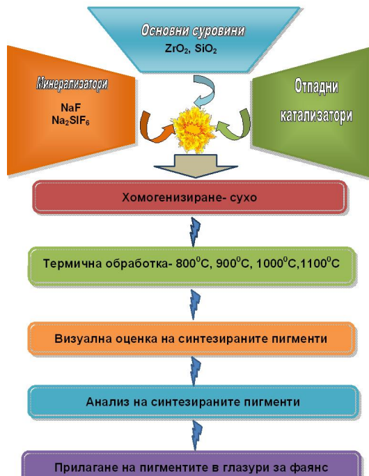
Фиг. 1 Технологична схема за синтез на пигментите
