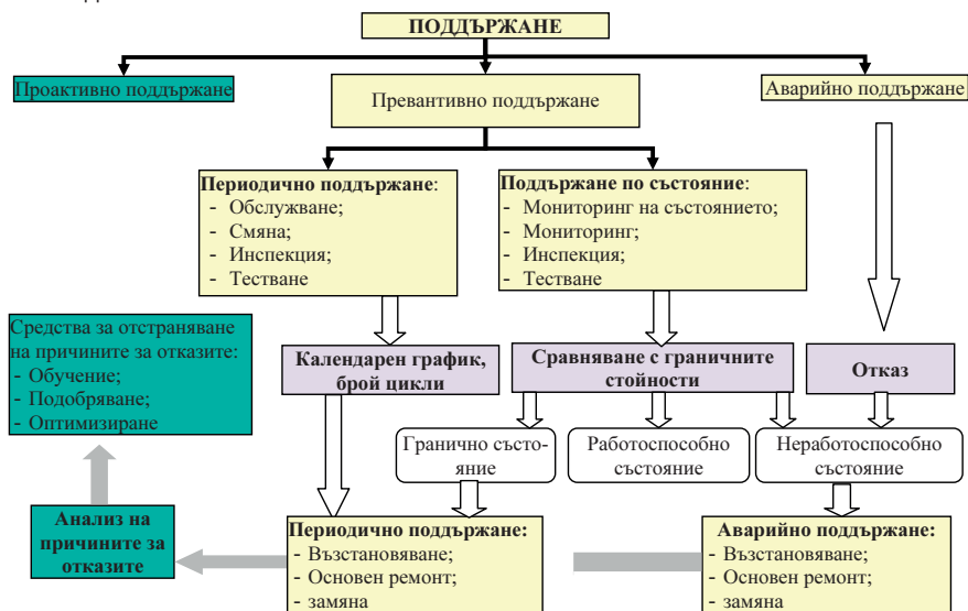
Фиг.1. Модел за поддържане според надеждността на машините [5], [SS-EN 13306 (2001)]
