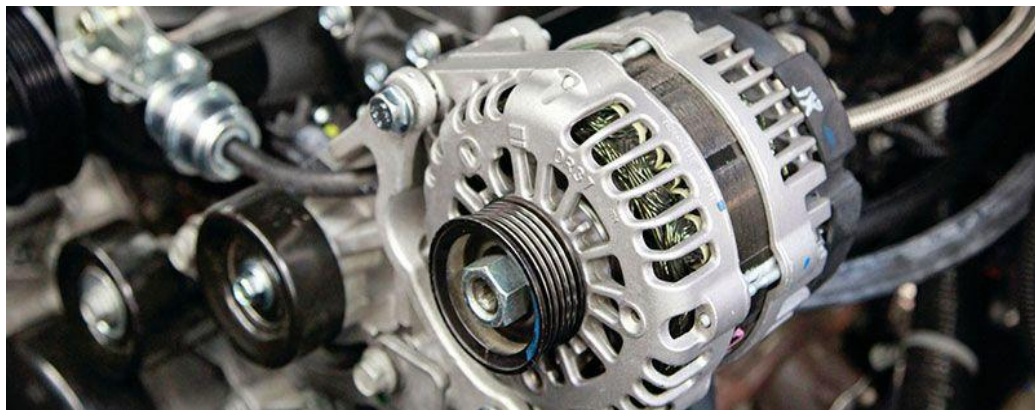
Фиг.1. Генератор за променлив ток с възбудителна намотка
