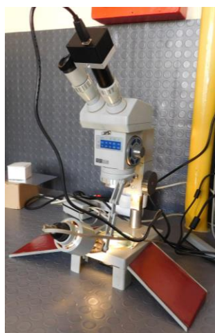
Фиг. 6. Измерване на модела а) стерео микроскоп “Carl Zeiss Jena“, б) Цифрово изображение и измерени стойности на 3D принтирания модел
