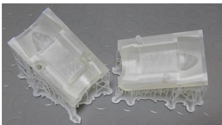
Фиг. 8. Физически 3D принтирани модели: а) зъбното колело със заключващ механизъм; б) леярски марки и сърце в) сърцева кутия
