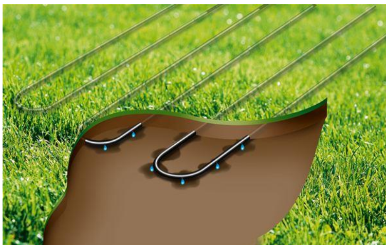
Фиг. 2 Капково подпочвено напояване
