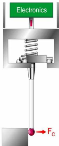
Фиг.3 ТИГ с тензосензори
