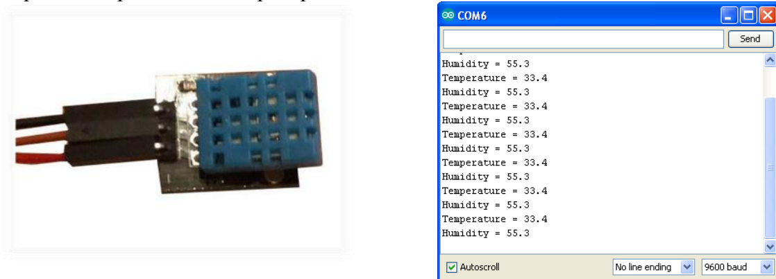
Фиг. 7 Модул DHT11 и оптични резултати за температурата и влажността на въздуха
