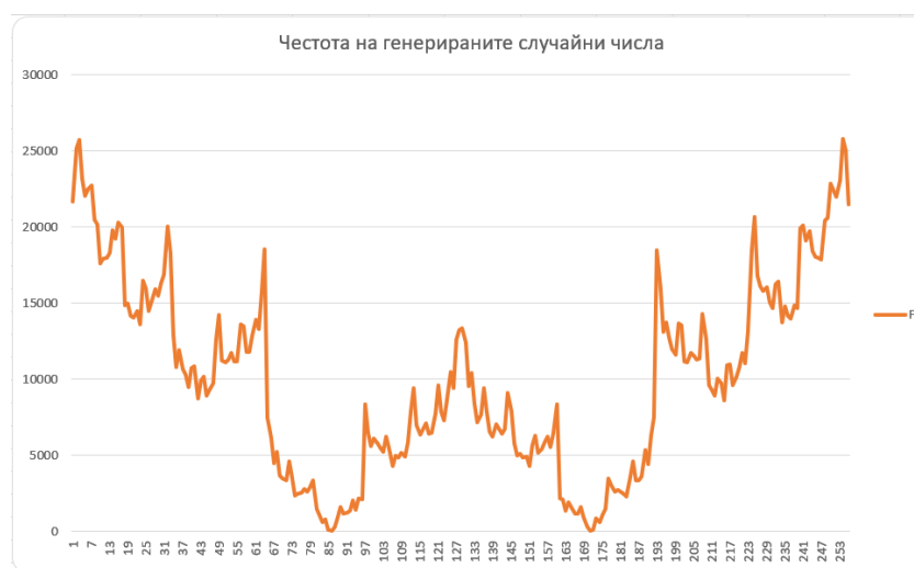
Фиг. 7 Дискретна плътност (на вероятността) на изходната последователност на ASG генератора
