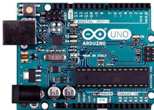
Фиг. 3 Микроконтролер Arduino Uno
