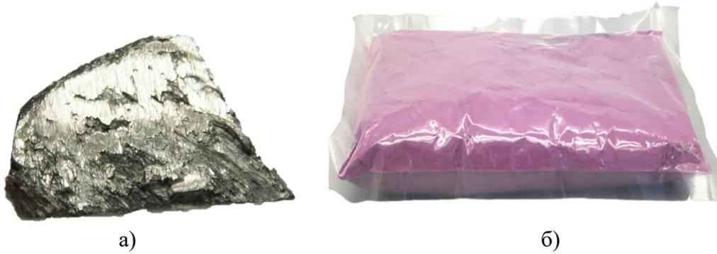
Фиг. 2 а) Er – метал; б) Er<sub>2</sub>O<sub>3</sub>
