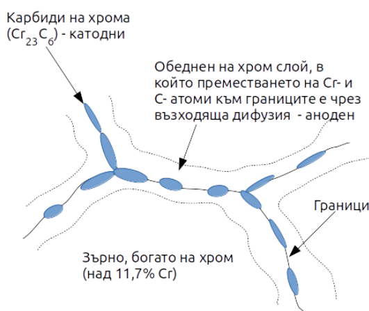
Фигура 3. Схема на микроструктурата на неръждаема стомана при некоректен режим на термично обработване
