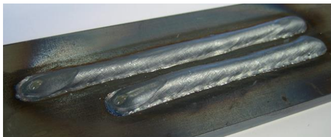
Фиг. 2. Външен вид на заваръчен шев, изпълнен с помощта на функцията HI DEPOSIT PULSE
