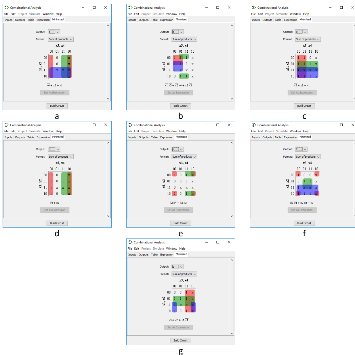
Фиг. 4. Минимизация на изходните функции (а...g) на кодовия преобразувател
