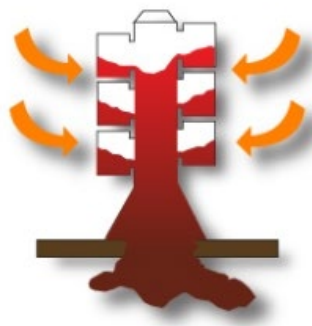
Фиг. 3 Изтичане на моделния комплект при изпичане
