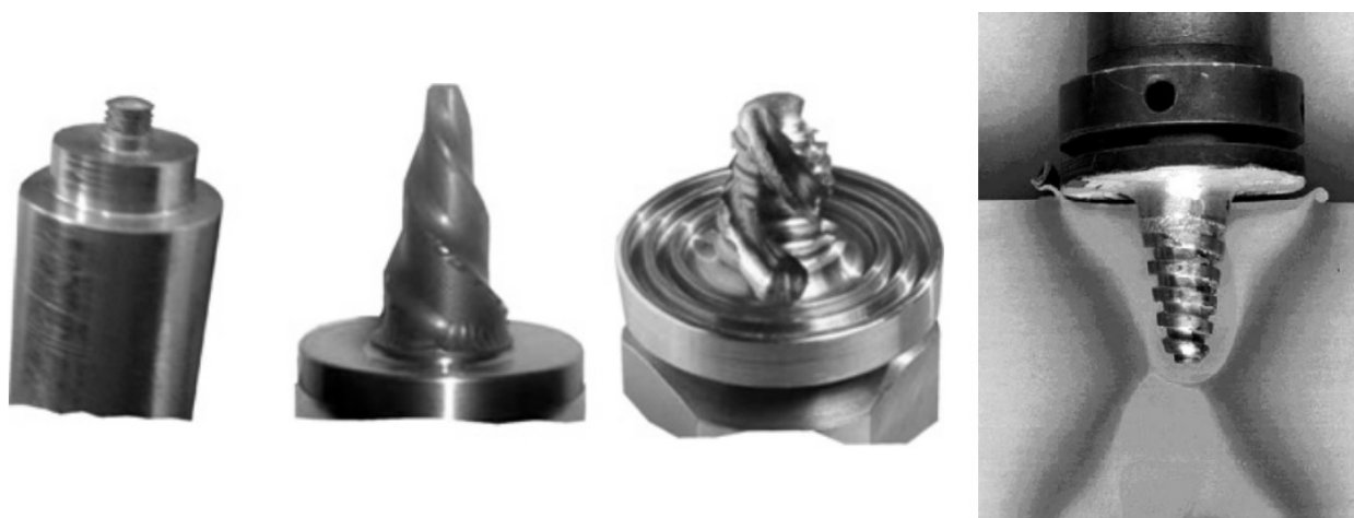
а) б) в) г) Фиг. 3. Външен вид на инструменти използвани при ЗТР: а) инструмент с традиционна форма; б) инструмент за дълбоко проваряване; в) инструмент със специална форма; г) инструмент за двустранно заваряване
