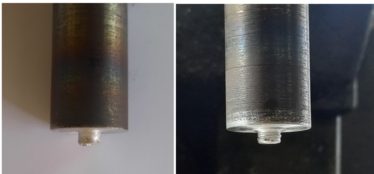
а) б) Фиг. 4. Външен вид на инструменти използвани в Русенски университет за ЗТР: а) инструмент с гладка цилиндрична форма на върха; б) инструмент с цилиндричен връх с резба;
