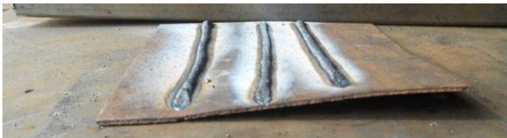
Фиг. 12. Деформации на метала при заваряване.
