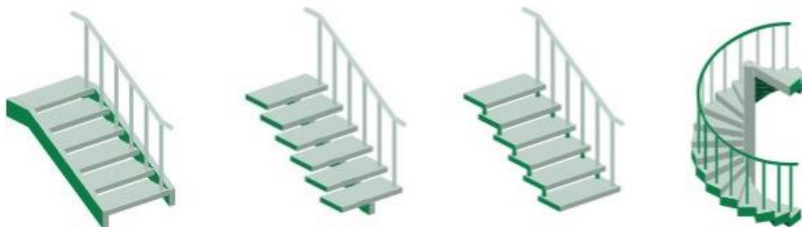
Рис. 5. Слева направо: схема лестницы на тетивах, косоурах, больцах и обсадной трубе.
