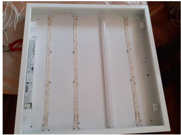
Фиг. 5. Осветителят с монтирани LED модули и захранващ драйвер
