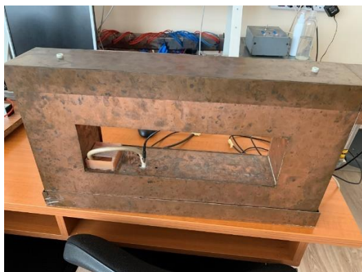
Фиг. 2. Макет и сензори за измерване на температура и относителна влажност на въздуха
