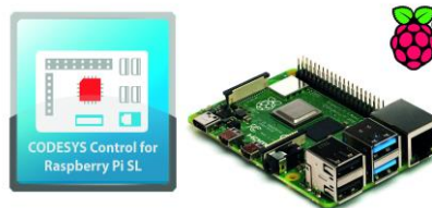
Фиг. 2 Софтуерно ПЛК, като контролен пакет за Raspberry Pi
