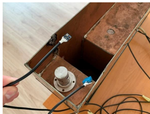
Фиг. 2. Макет и сензори за измерване на температура и относителна влажност на въздуха
