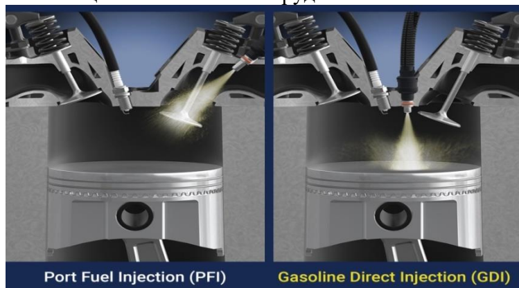
Фиг. 25. Конвенционален двигател (PFI) и двигател с директно впръскване (GDI)
