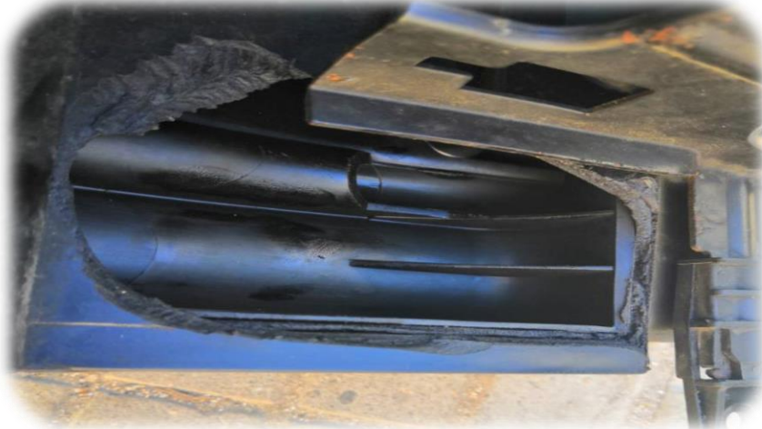
Фиг. 13. Счупен всмукателен колектор в следствие на детонационно горене
