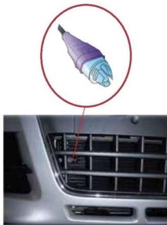
Фиг. 4. Преобразувател за температура на околната среда
