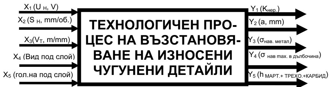
Фиг.2. Модел на технологичен процес на възстановяване на износени чугунени детайли
