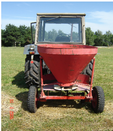
Фиг.1. Общ вид на агрегата (трактор – експериментална разпръскваща машина) за разпръскване на гранулирана торова постеля от бройлери
