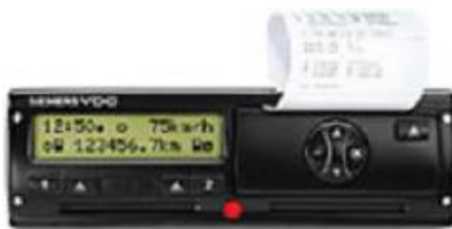
Фиг. 2. Общ вид на дигитален тахограф Сименс DT50 1381
