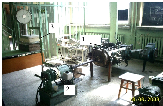
Фиг.2. Общ вид на експерименталната уредба със задвижващия електродвигател и устройството за отчитане на въртящия момент:
