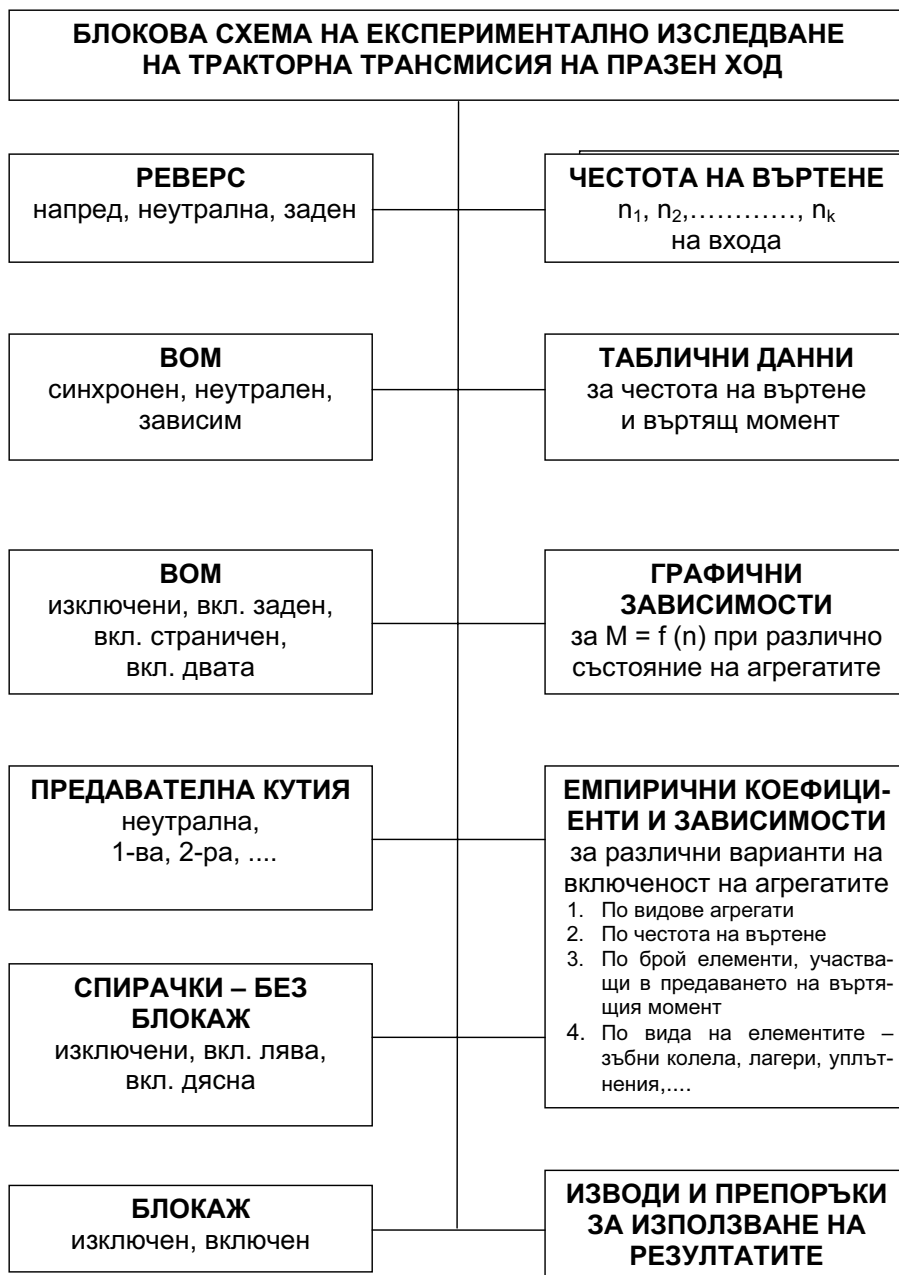
Фиг.3. Блокова схема на методиката за изследване загубите на празен ход в тракторна трансмисия уплътнения. Освен това има и по-голяма разлика в предавателните числа, което означава, че честотата на изходящия вал ще се изменя в много по-широки граници.
