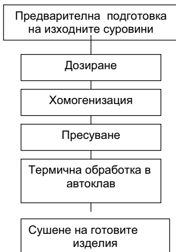
Фиг.1. Технологична схема за получаване на калциево-силикатно изделие
