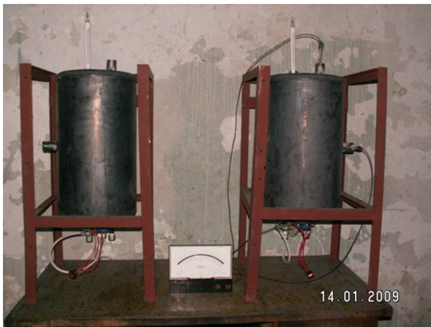
Фигура 2. Уредба за определяне на електрохимичните характеристики и експлоатационната надеждност на галванични аноди (протектори)
