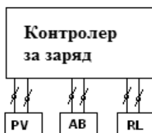
фиг.1Блокова схема на фотоволтаична система
