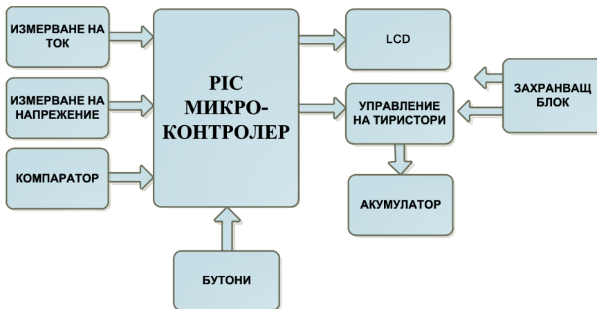
Фиг. 1 Блокова схема на микропроцесорната система
