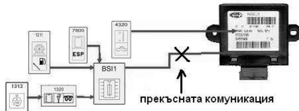
фиг.5 Прекъсната комуникация между блока за управление на РЕФ и блока за управление на двигателя
