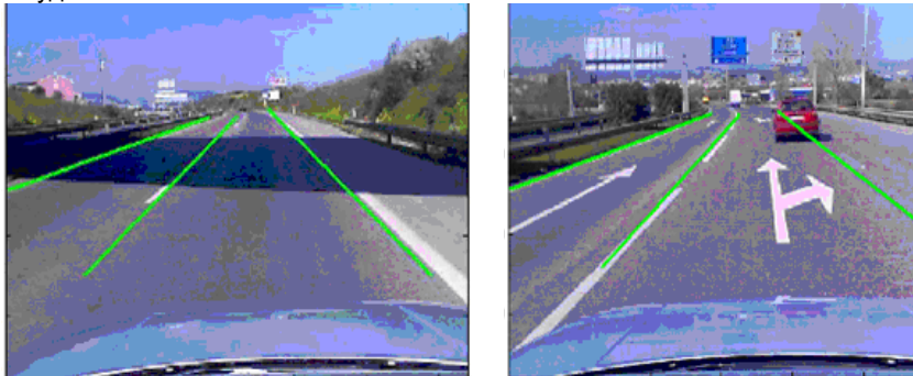
Фиг. 2. Използване на филтри за цифровия видеосигнал за да се очертаят контролните линии за страничната дистанция.
