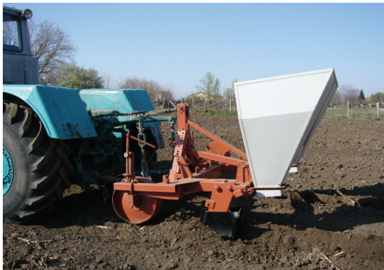
Фиг.1. Общ вид на преустроен прорезвач-ходообразовател с бункер за мулч
