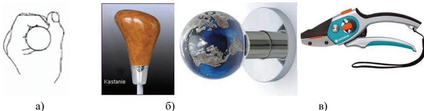
Фиг.2. Видове ръкохватки за силово хващане с цяла длан
